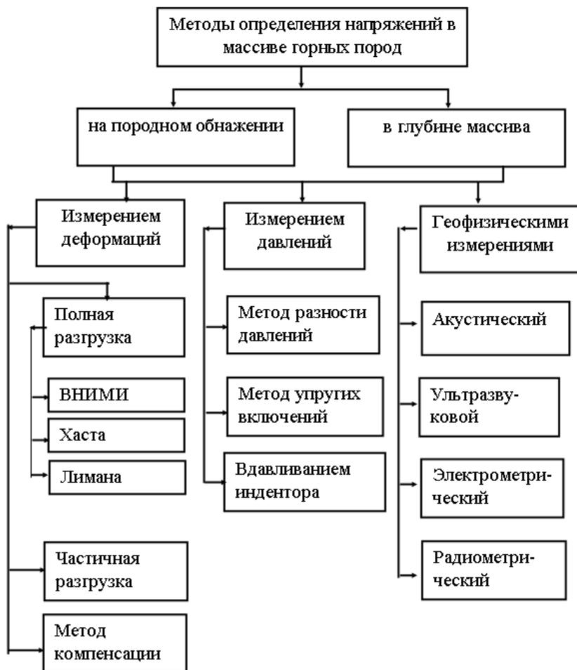
Рисунок 2.18 - Классификация методов измерения напряжений
